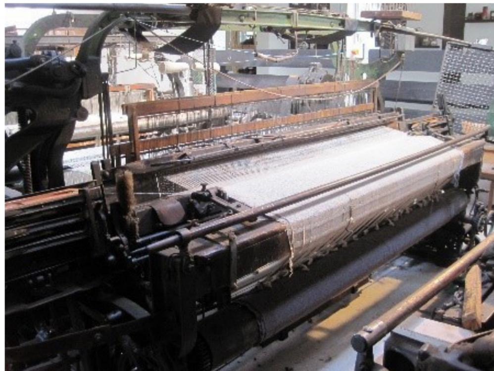
damit das Schiffchen zwischen die Kettfäden kam. Nach jedem Schuss drückte der Baum den Schussfaden an das fertige Gewebe. Der sog. Schläger katapultierte das Schiffchen fort, so dass es mit 110 km/h hin und her sauste. Sollte es sich einmal aus der Verankerung lösen, so konnte das hochgradige Verletzen für den Weber zur Folge haben.
